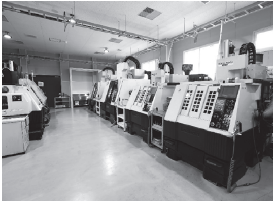
写真2 恒温室で加工を行うことで精度を追求する
